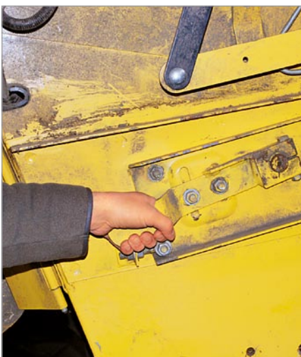
Verstellung des Abstands Einzugsschnecke zu Schneidwerksmulde. Fotos: Autor
