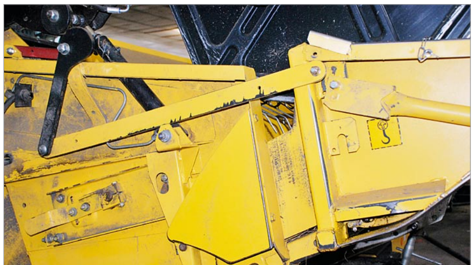
Blanke Stellen vorn am Schneidwerk deuten auf eine falsche Einstellung der Halmteiler hin und müssen korrigiert werden, da sonst auch hier Verluste entstehen.
